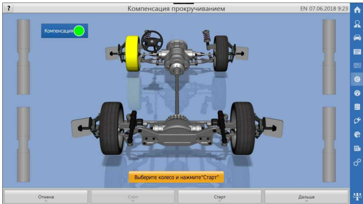
Рисунок 5.16 - Окно компенсации прокручиванием - выбор колеса
