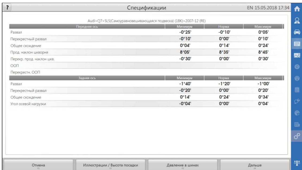
Рисунок 5.10 - Окно спецификаций автомобиля
