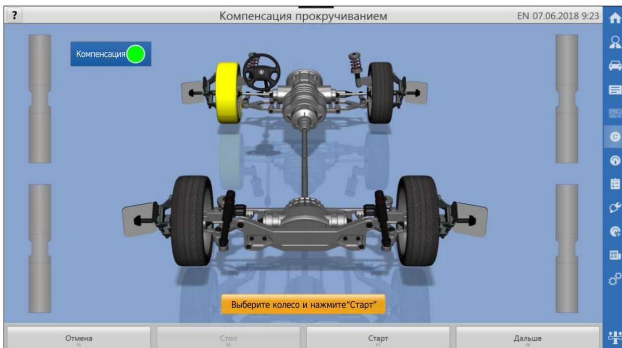
Рисунок 5.16 - Окно компенсации прокручиванием - выбор колеса
