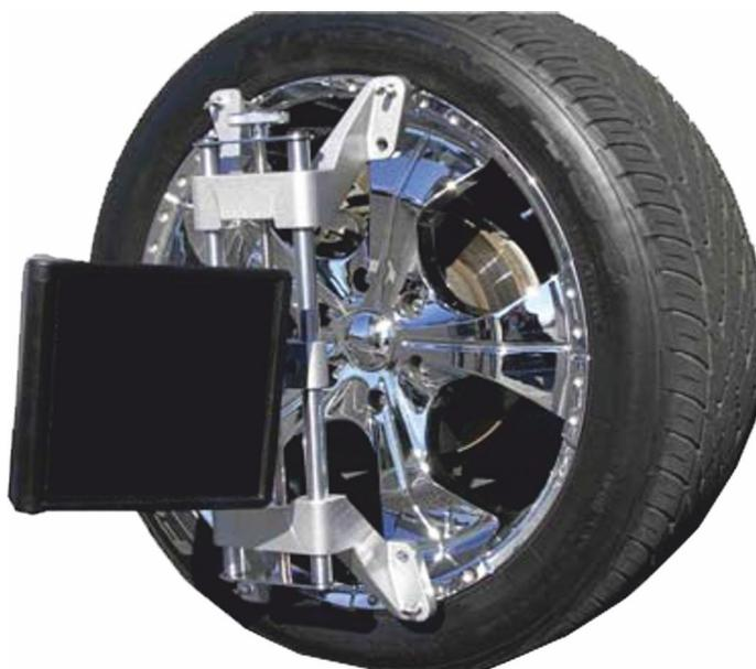
Рисунок 5.13 - Закрепление адаптера на колесе
