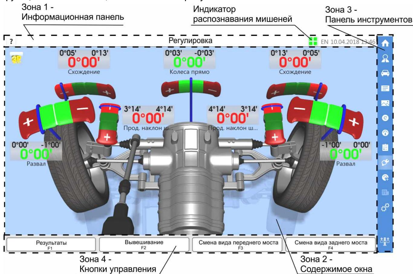
Зона 1 – информационная панель, отображает кнопку встроенной справки, заголовок окна, раскладку клавиатуры, текущие дату и время, индикатор распознавания мишеней (в режиме измерений).
