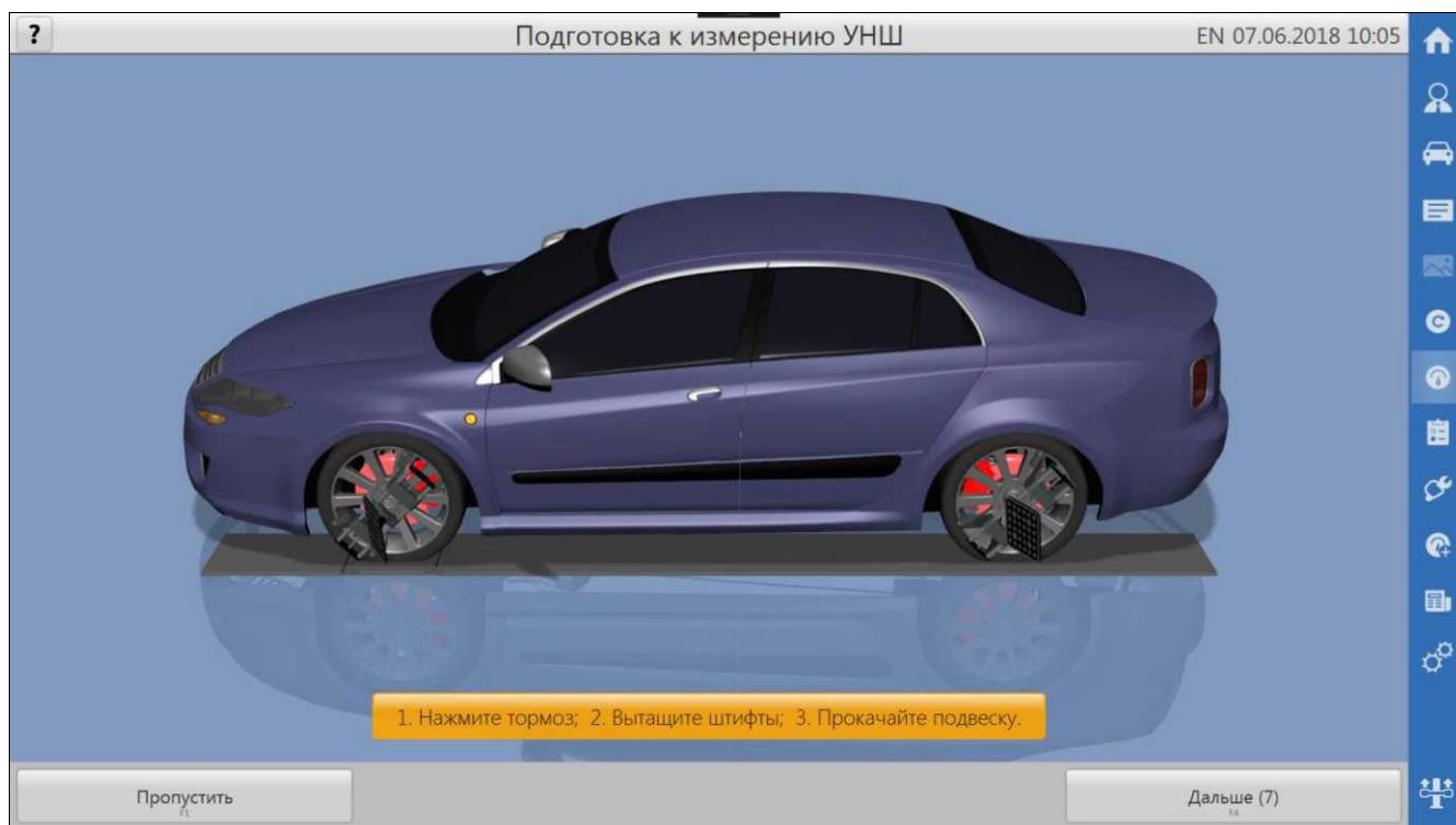
Рисунок 5.17 – Окно подготовки к измерениям УНШ
