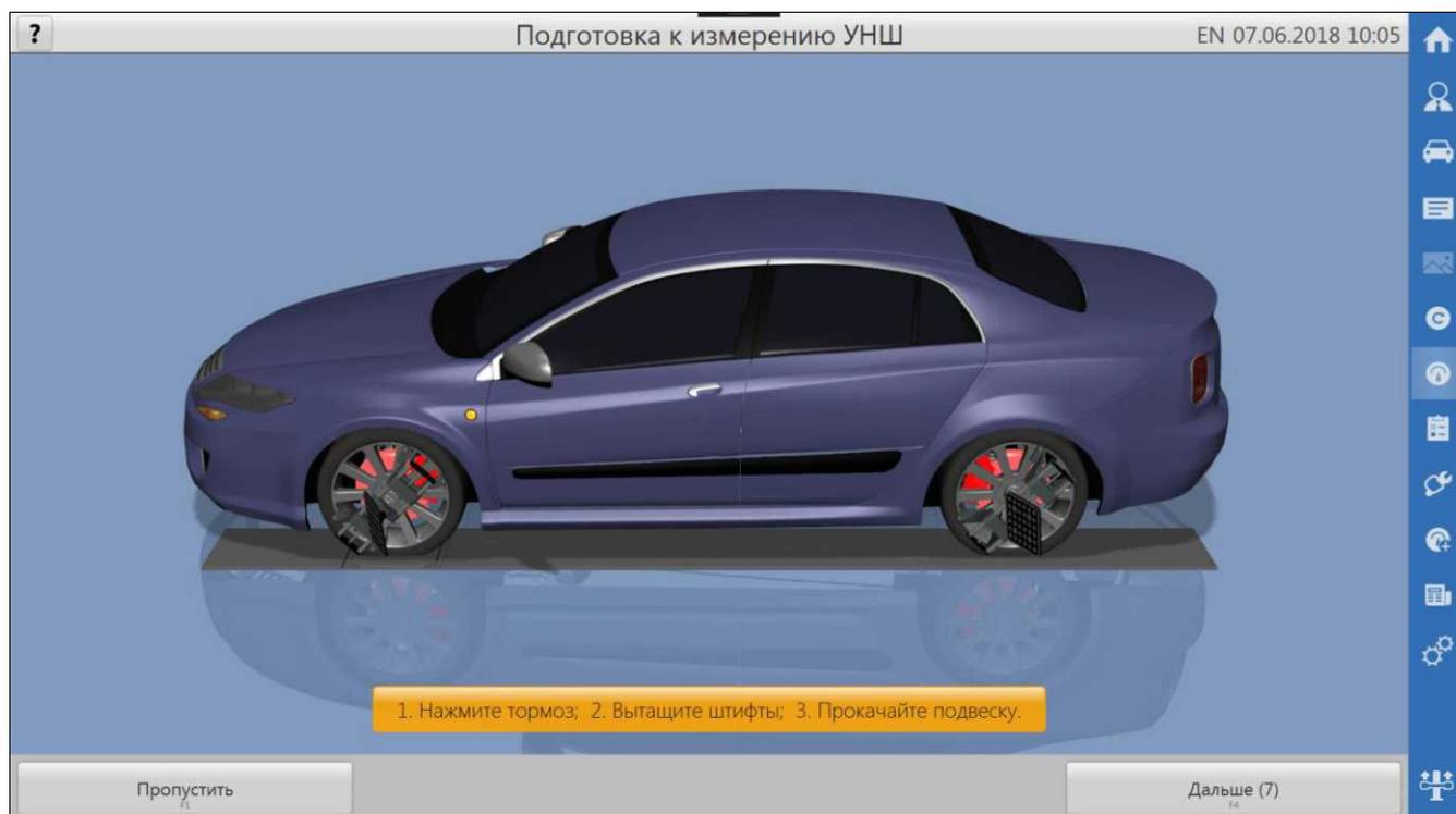
Рисунок 5.17 – Окно подготовки к измерениям УНШ
