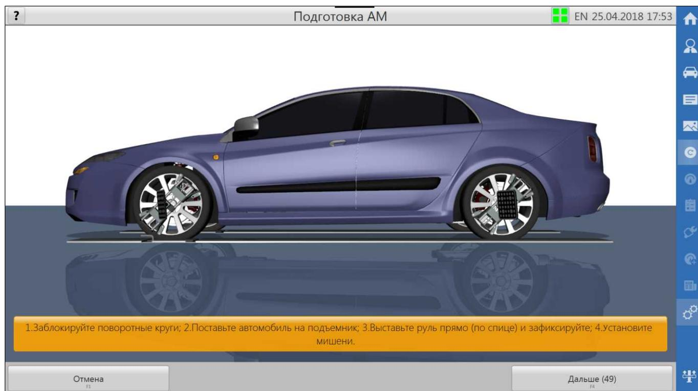
Рисунок 5.11 – Подготовка автомобиля
