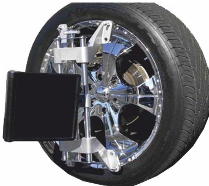
Рисунок 5.13 - Закрепление адаптера на колесе
