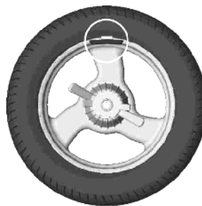
Рисунок 6.6 - Груз установлен в «12 часов»
